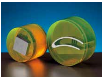
Стальные детали, запрессованные в EpiFix и EpiDye
